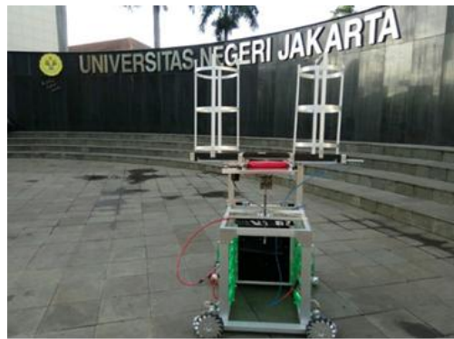
Gambar 2. 1 Robot Abu Pelempar Cakram Tim Biruni UNJ
