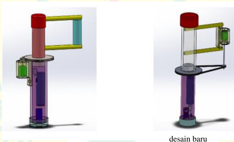
Gambar 5.1 Perbandingan desain Charger Portable Tipe Centrifugal
