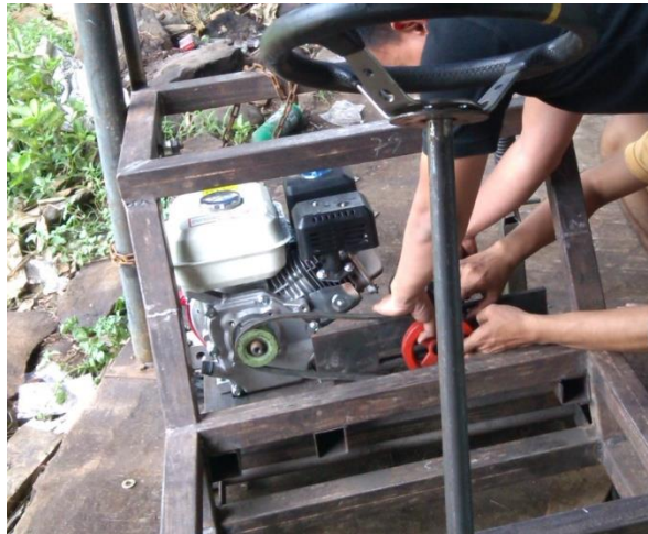
Gambar.3.21. Proses Perakitan Puli dan Pompa Hidrolis
