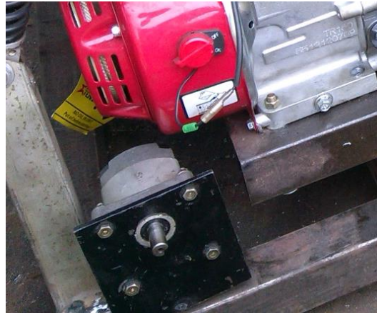
Gambar 3.22.Motor Hidrolik yang Telah Dirakit
