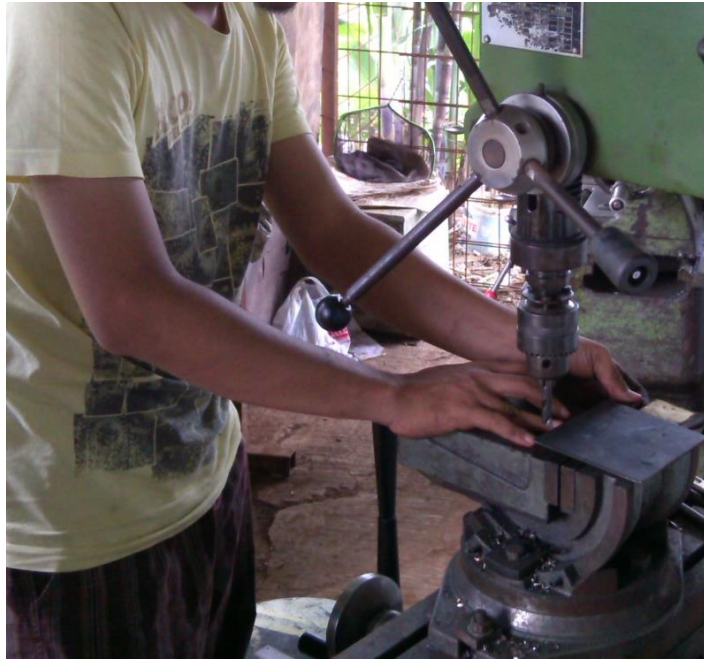
Gambar 3.19 Proses Pembuatan Dudukan Motor hidrolik
