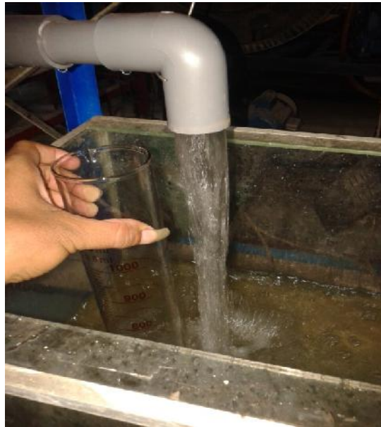
Gambar 3.28 Persiapan pengujian debit air.
