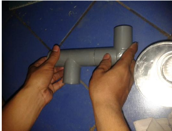
Gambar 3. 12 Menyambung elbow 90 0 dengan sambungan T
