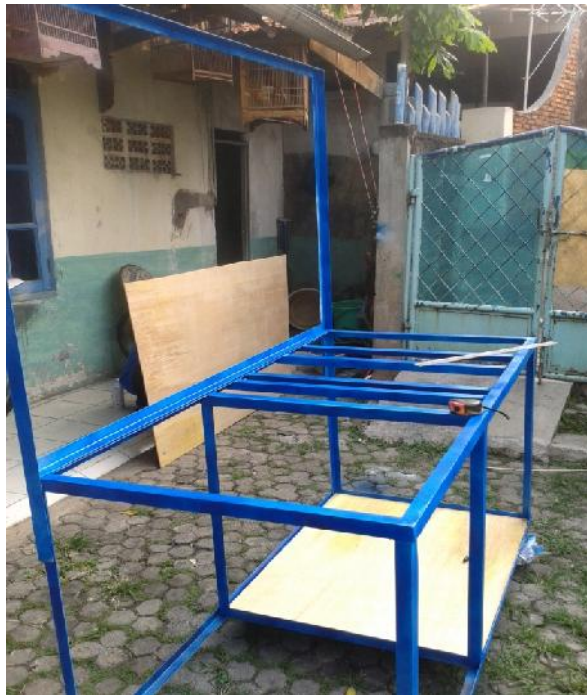
Gambar 3.7 Mengecat finishing rangka alat uji.
