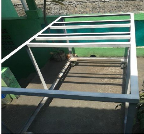
Gambar 3.6 Pemberian warna dasar rangka alat uji.
