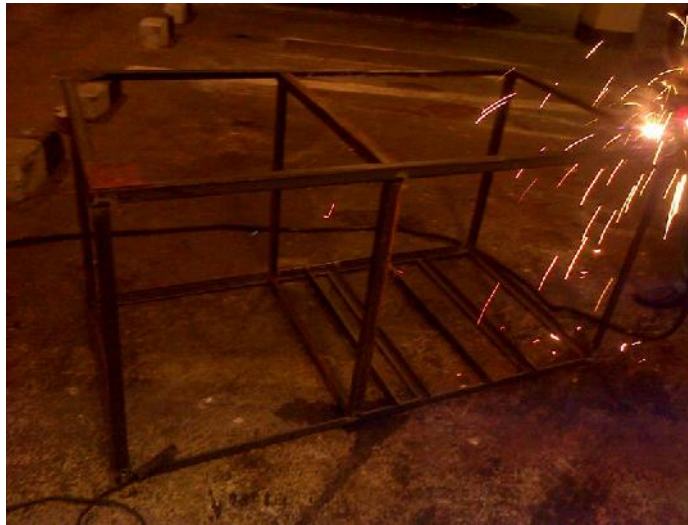
Gambar 3.2 Membentuk rangka dasar alat uji.
