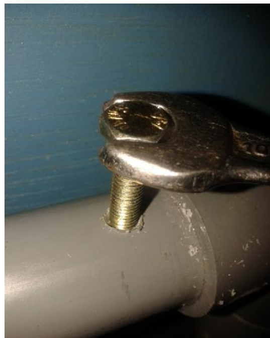
Gambar 3.18 Mengemal ulir dengan menggunakan baut.
