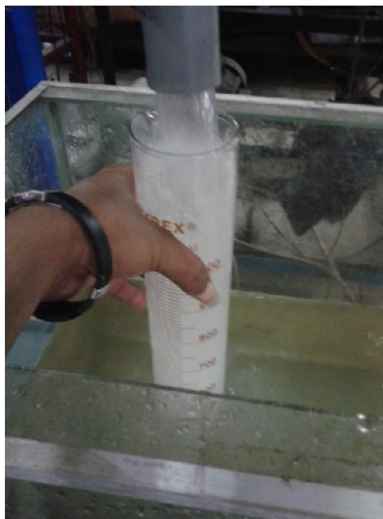
Gambar 3.29 Pengisian gelas ukur guna mengukur volume air
