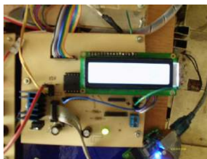
Gambar 4.12 Rangkaian Mikronkonnroller avr atmega 8535
