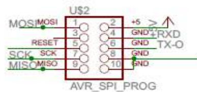
Gambar 3.16 Skema Rangkaian Interfacing Mikronkontroller dengan Komputer
