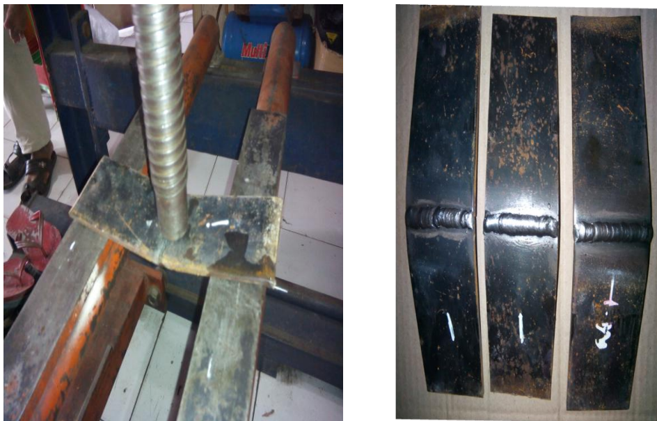
Gambar : 3.4. Benda Kerja Setelah di las dan Uji Bending.
