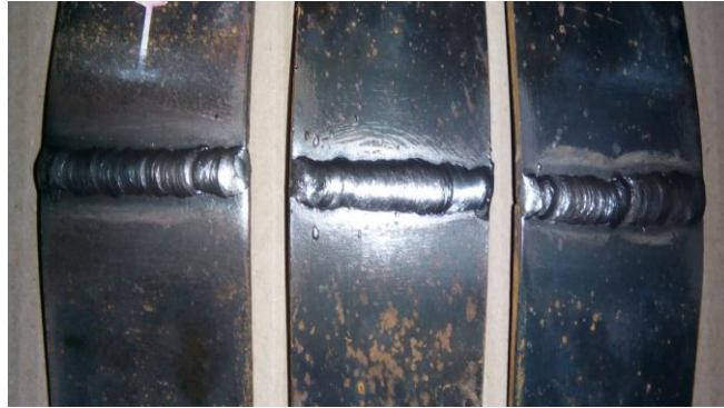
Gambar 3.15. . Hasil Proses Bending Kampuh U
