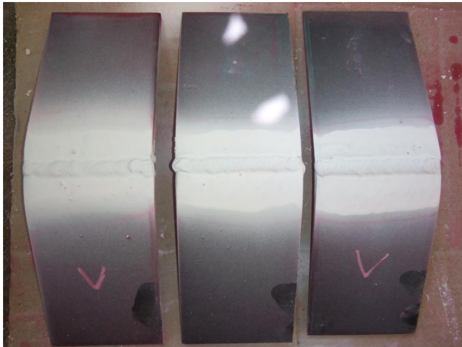
Gambar 3.13. Hasil Penyemprotan Cairan Developer Pada Kampuh V
