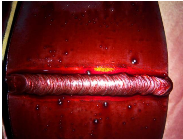
Gambar 3.8. Hasil Penyemprotan Penetrant Kampuh J
