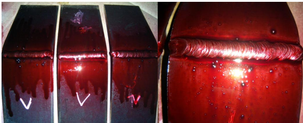
Gambar : 3.5. Benda Kerja Setelah di Uji Bending dan di semprot Dye penetrant
