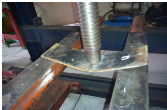
Gambar 3.14. Proses Bending Kampuh U
