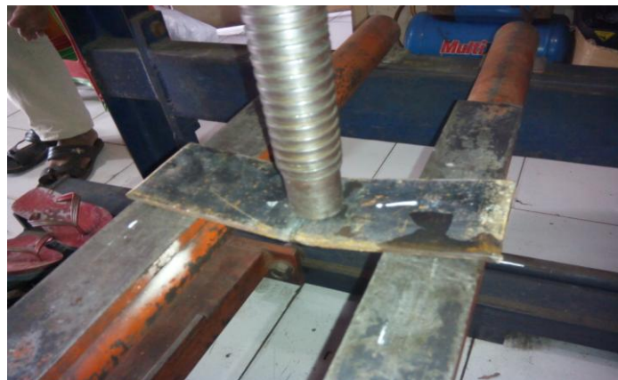
Gambar 3.18. Proses Bending Kampuh I
