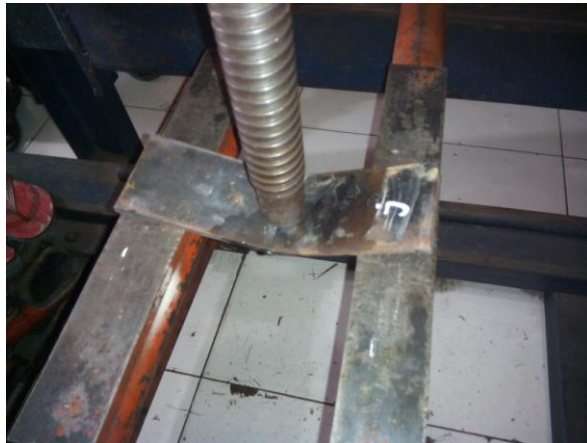
Gambar 3.6. Proses Bending Kampuh J
