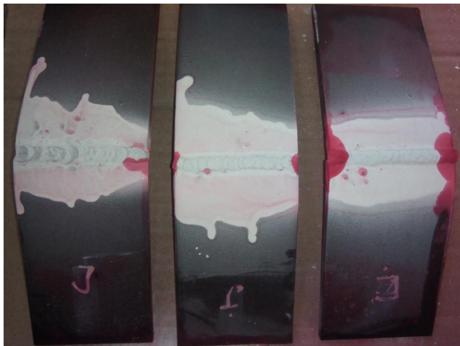
Gambar 3.9. Hasil Penyemprotan Cairan Developer Pada Kampuh J
