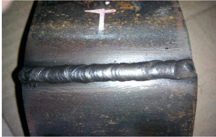
Gambar 3.19. Hasil Proses Bending Kampuh I
