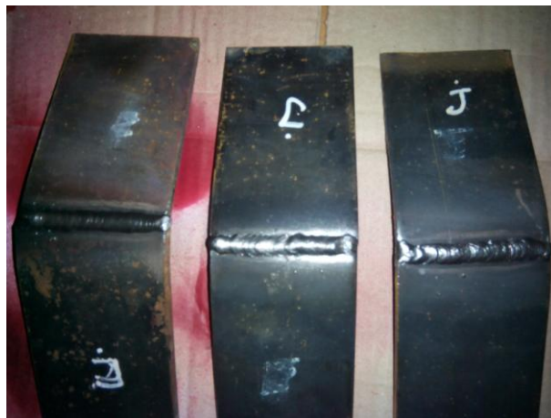
Gambar 3.7. Hasil Proses Bending Kampuh J
