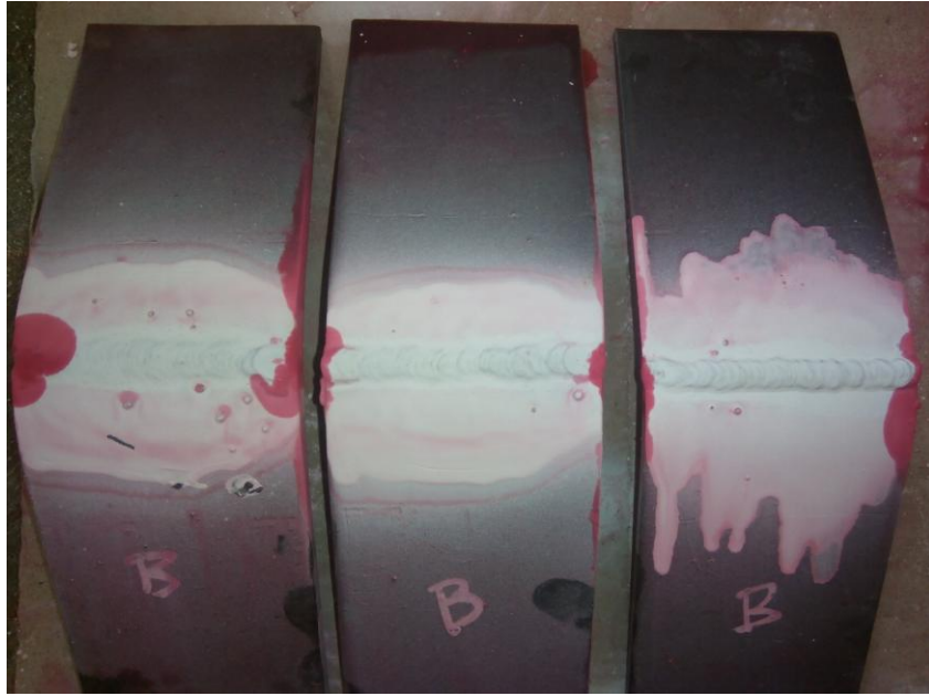
Gambar 4.5. Hasil Uji Bending Kampuh Bevel
