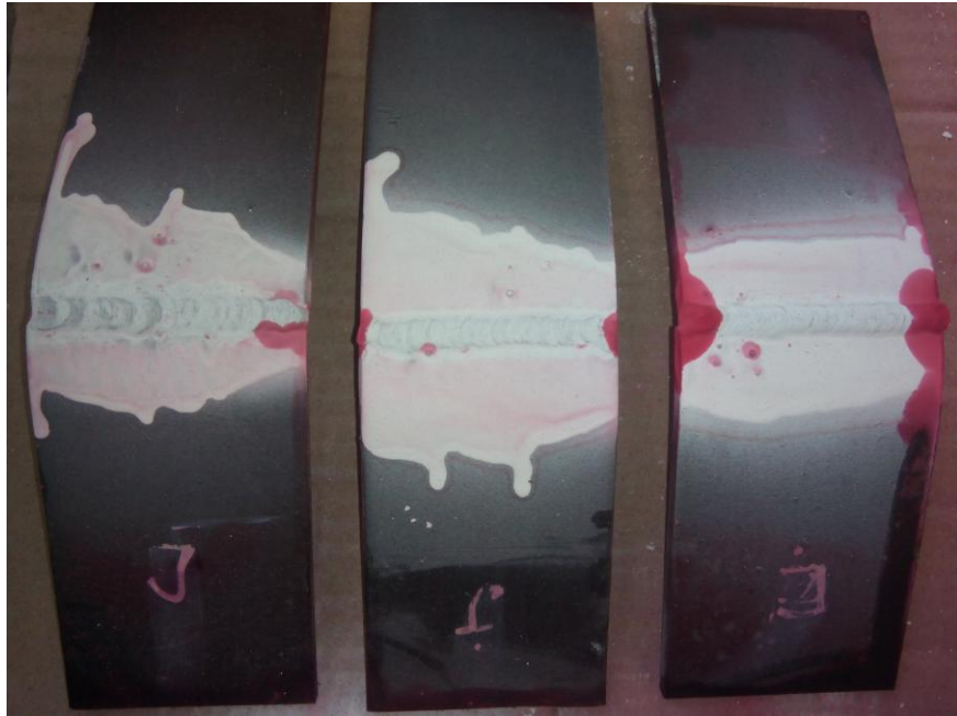
Gambar 4.1. Hasil Uji Bending Kampuh J
