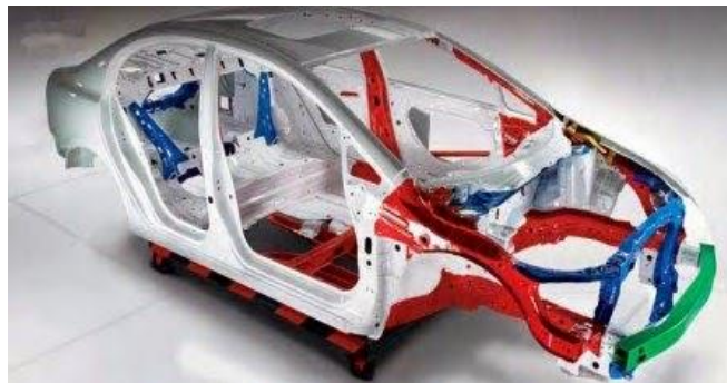
Gambar 2.2. Konstruksi Monocoque Body
