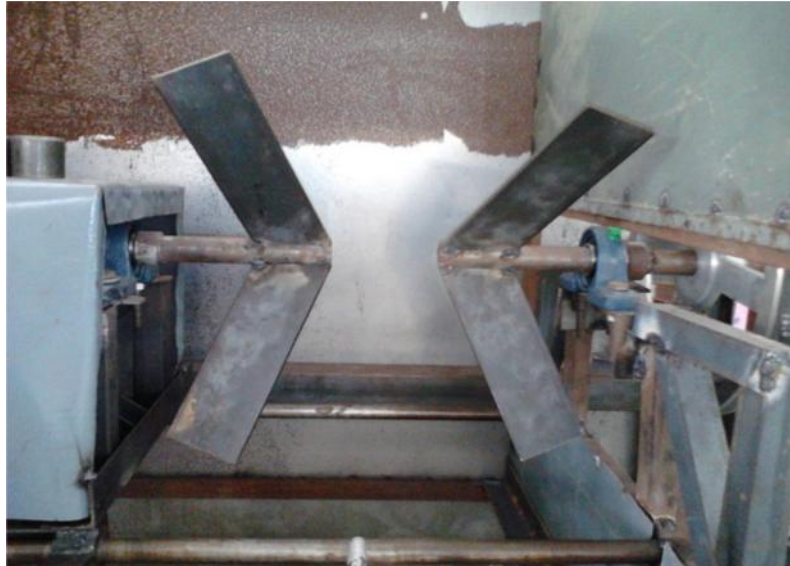
Gambar 3.25. Pemasangan bearing kedudukan rangka
