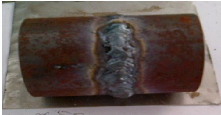
Gambar 4.11. hasil Pengelasan pipa job 2
