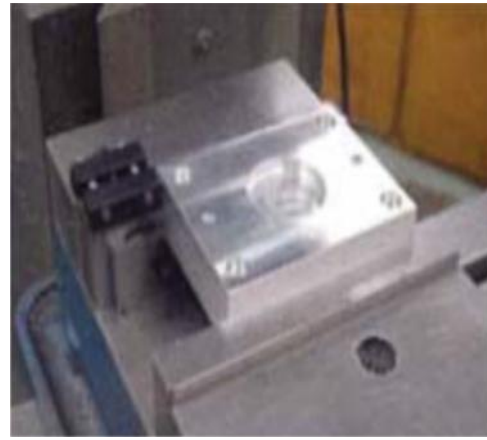
(e) Pembatas ragum (vise stop) yang dipasang menyatu dengan mulut ragum
