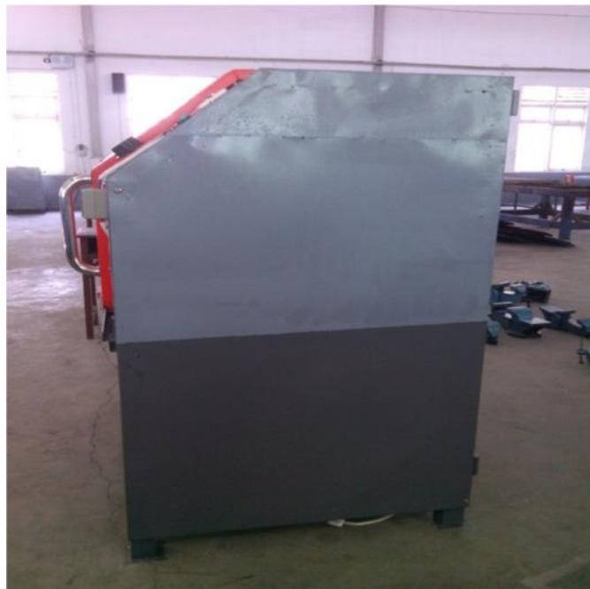
Gambar 3.38. Pemasangan cover bagian samping kiri.
