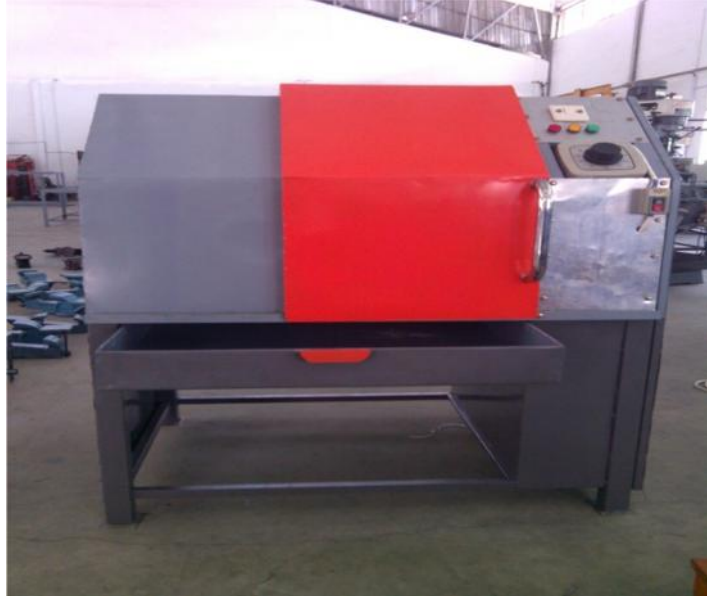
Gambar 3.39. Pemasangan cover bagian depan.
