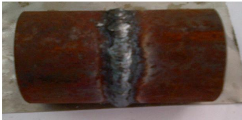
Gambar 4.19. Hasil Sambungan Pipa dengan ketebalan 3,2 mm dan Diameter \varnothing 50 mm dengan kecepatan putaran 2 rpm.
