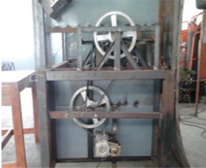
Gambar 3.27. Pemasangan poros ke bearing tekan.
