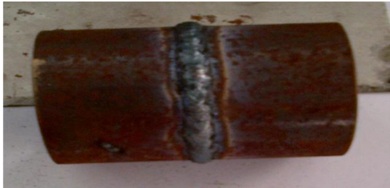
Gambar 4.20. Hasil Sambungan Pipa dengan ketebalan 3,2 mm dan Diameter \varnothing 50 mm dengan kecepatan putaran 2,25 rpm.
