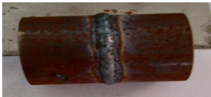
Gambar 4.13. hasil Pengelasan pipa job 4
