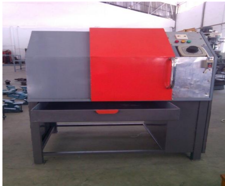
Gambar 4.1. Alat bantu pengelasan pipa untuk posisi 1 G
