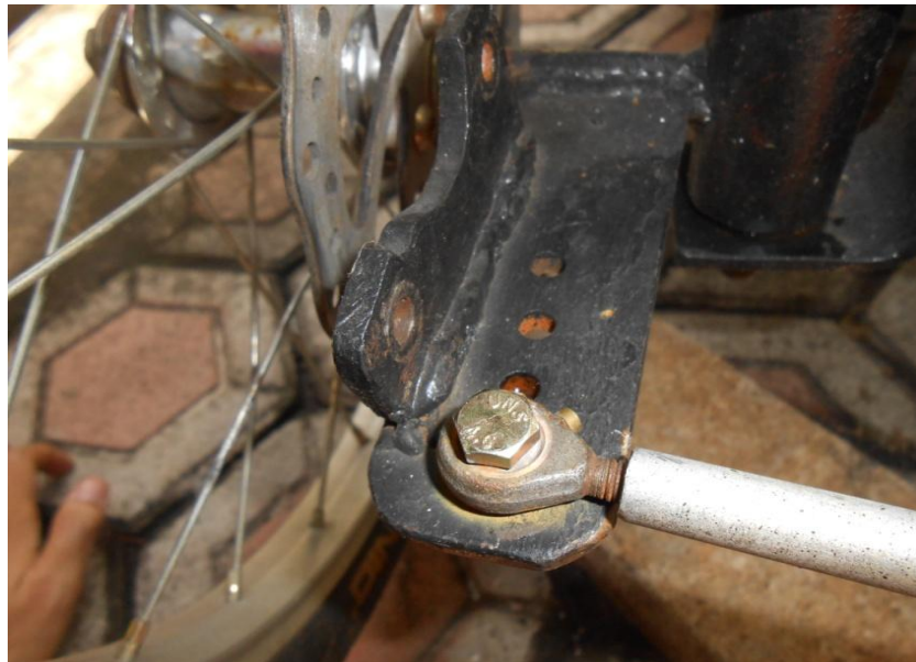
Gambar 3.12 dudukan disc break
