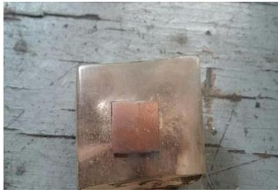
Gambar 4.1 Spesimen Uji Laju Korosi *Elektroplating* Tembaga
