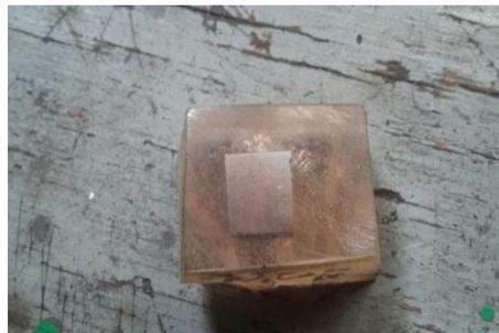
Gambar 4.3 Spesimen Uji Laju Korosi *Elektroplating* Tembaga – Nikel - Ferro
