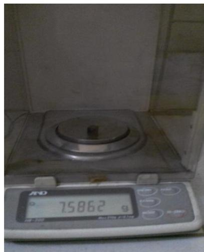
Gambar 3.5 Proses Penimbangan Spesimen
