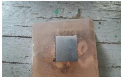
Gambar 4.2 Spesimen Uji Laju Korosi *Elektroplating* Nikel
