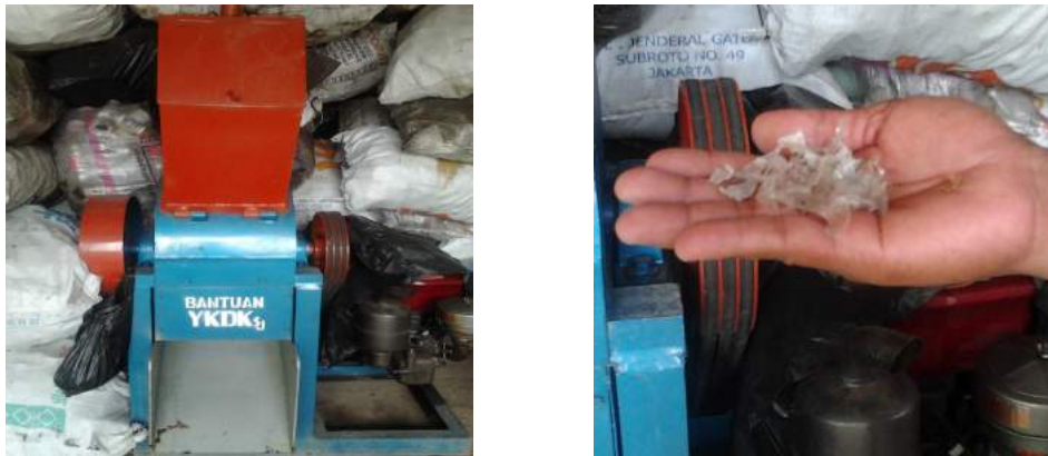
Foto 3.4 Mesin Pencacah dan Hasil Cacahan Sampah Plastik
