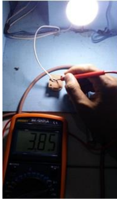
Gambar 4.3. Pengukuran Tegangan Sensor LDR Ruang Dapur
