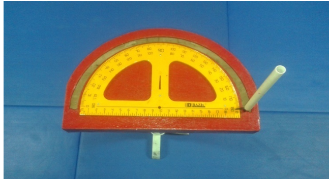
Gambar 3.2 : Alat pengukur fleksibilitas putaran pinggang
