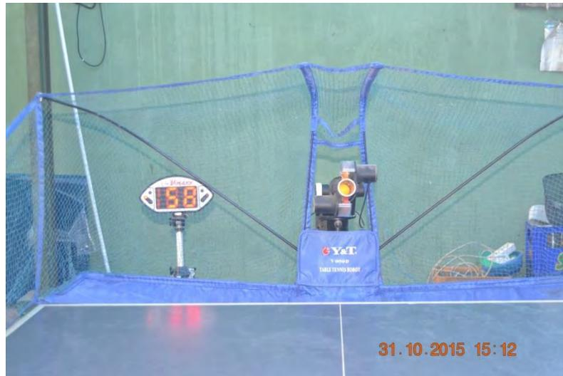
**Gambar: Alat Pengukur Kecepatan (Radar)**
