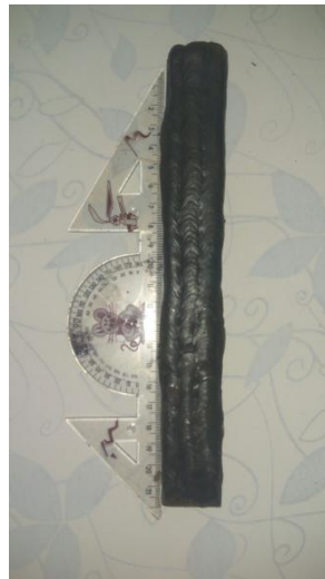
Gambar 3.6 Hasil Las Penebalan Permukaan. (bagian atas)
