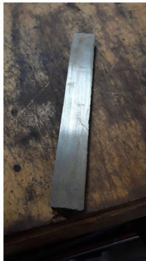
Gambar 3.10 Hasil Las yang Sudah Terpisah dari Base Metal dan Telah Dihaluskan Permukaannya.
