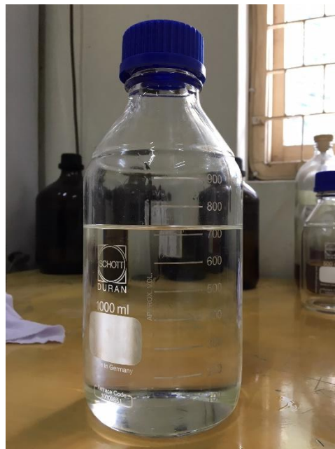
Sampel Minyak Transformator
