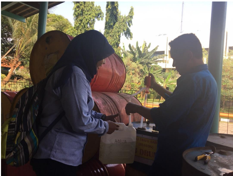
Pengambilan Minyak Transformator Baru
