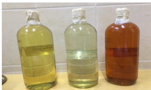
Gambar 3.10. Minyak Transformator Baru (kiri dan tengah) dan Minyak Transformator Bekas Pakai (kanan) (Sumber : Dokumentasi Pribadi)
