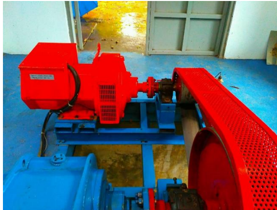
Gambar 4.14. Pulley dan Generator Pada Laboratorium
