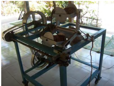
Gambar 2. 17 Mesin pemilin serat agel (Paryanto, Marwati, & Rahmawaty, 2011, Peningkatan Produktivitas Kelompok Pengrajin Berbahan Baku Serat Alami, p. 1-17)
