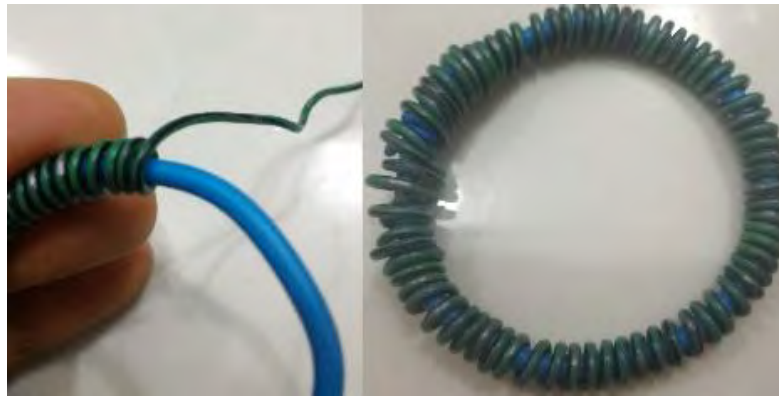
Gambar 3. 2 Proses Pelilitan Kabel NYAF (Sumber: Dokumentasi Pribadi)
