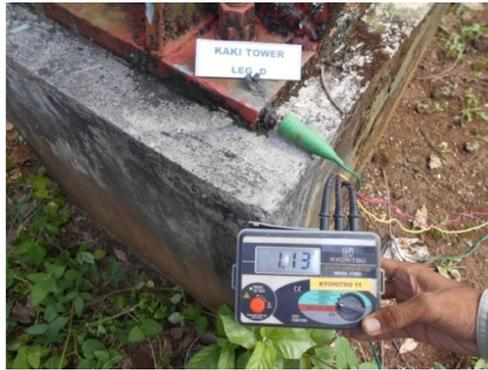
**Gambar 4.13 – Pengukuran Pentanahan Pada Kaki Tower D**
