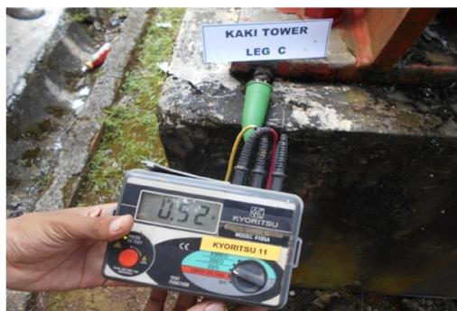
**Gambar 4.12 – Pengukuran Pentanahan Pada Kaki Tower C**
