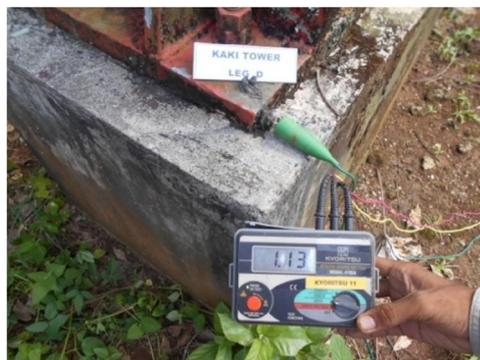
**Gambar 4.11 – Pengukuran Pentanahan Pada Kaki Tower B**
