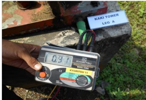
**Gambar 4.10 – Pengukuran Pentanahan Pada Kaki Tower A**
