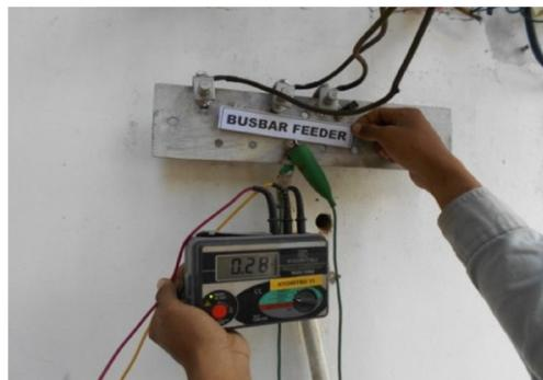
**Gambar 4.14 – Pengukuran Pentanahan Pada *Busbar Feeder***
