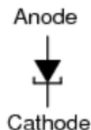
5. Dioda tunnel atau terowongan mengeksplorasi fenomena kuantum aneh yang disebut *tunneling* resonansi untuk memberikan resistensi negatif karakteristik bias maju. Ketika tegangan bias maju kecil diterapkan di sebuah terowongan dioda, saat itu dioda tunnel mulai melakukan kenaikan
