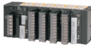
Gambar 2.8. Bentuk Fisik PLC Sumber: www.belajarplc.com
