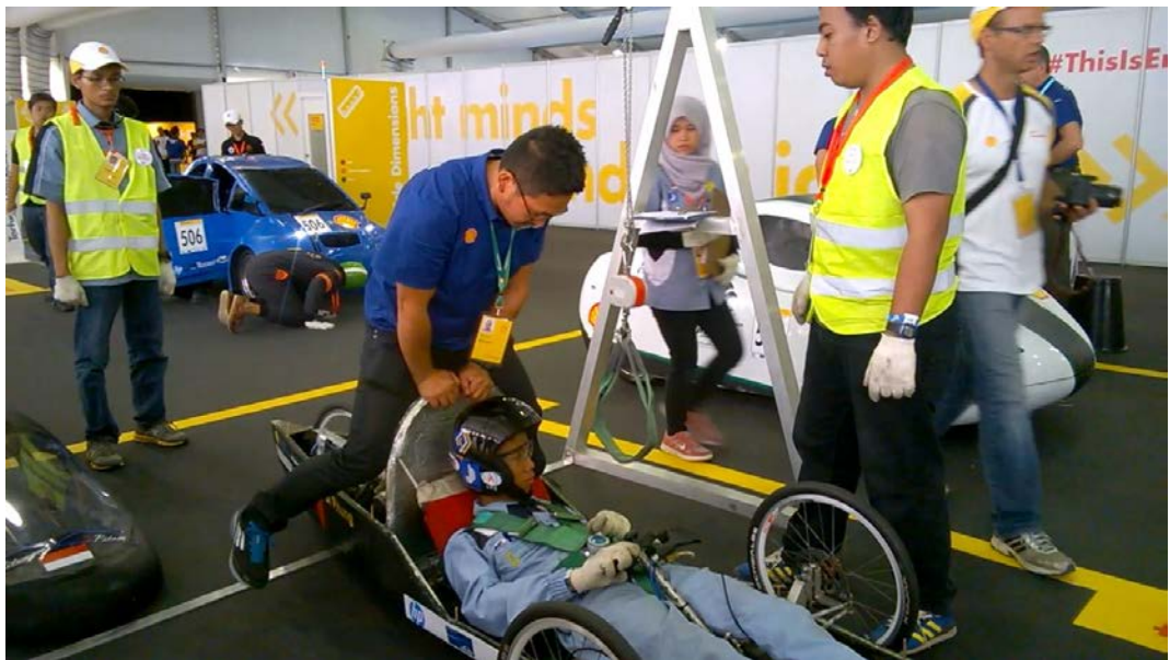
Gambar 2.15 contoh pengujian roll bar oleh shell
