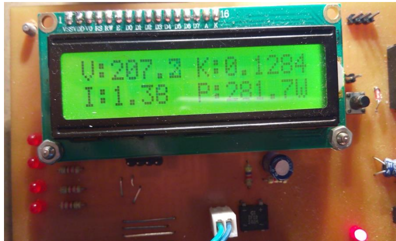
Gambar 3 Hasil pengukuran tegangan dari tampilan layar LCD Sumber Dokumentasi
