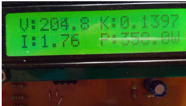
Gambar 7 Hasil pengukuran tegangan dari tampilan layar LCD Sumber Dokumentasi
