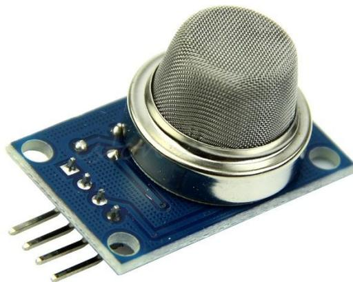
**Gambar 2. 3** Sensor Asap MQ2
