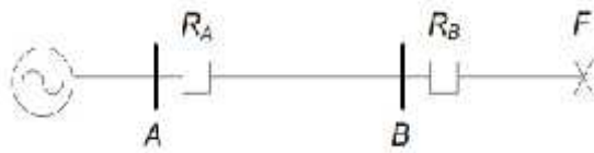
Gambar 2.2. Koordinasi relay proteksi Sumber : Niyomphant, dkk : 2012
