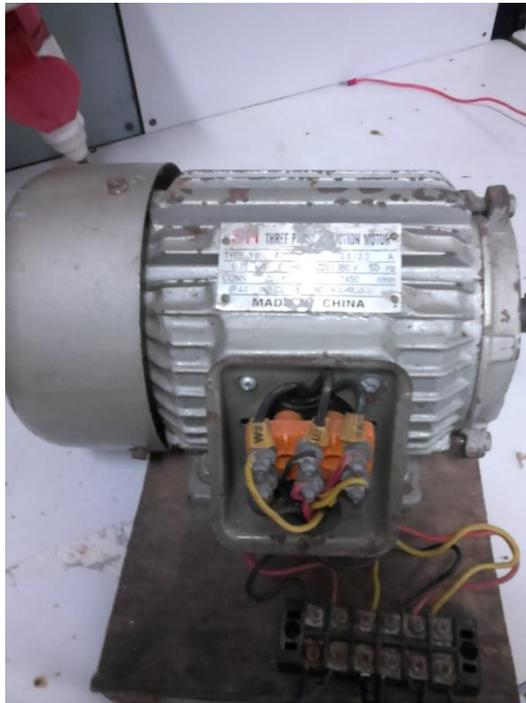
**Gambar 3.2** Motor Induksi 3 fasa
