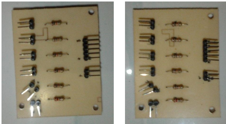
Gambar 4.4 Rangkaian sensor photodiode dan limit switch untuk lengan penggeser L (kiri) dan KG (kanan)
