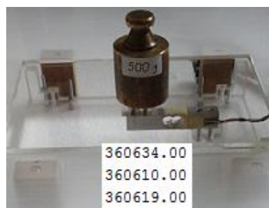
Gambar 4.12 Kalibrasi load cell dengan anak timbangan 500g
