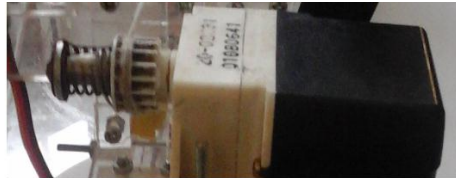
Motor dc gearbox untuk gerak vertikal lengan KG berputar berlawanan arah jarum jam
