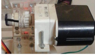
Motor dc gearbox untuk gerak vertikal lengan L berputar searah jarum jam
