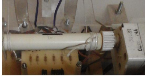
Motor dc gearbox untuk gerak horisontal lengan L berputar berlawanan arah jarum jam
