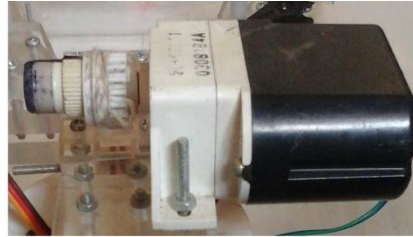
Motor dc gearbox untuk gerak vertikal lengan L berputar berlawanan arah jarum jam
