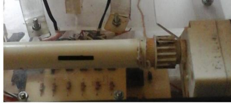
Motor dc gearbox untuk gerak horisontal lengan KG berputar searah jarum jam
