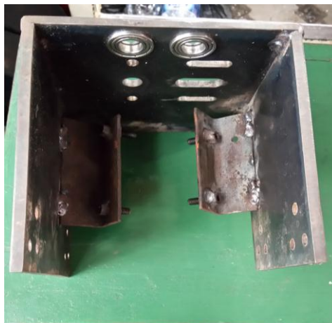
Gambar 3.5 Housing dengan Besi plat 6 mm
