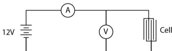
Gambar 3. 3. Rangkaian Pengujian Generator Elektrolisis tanpa PWM
