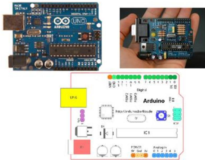
Gambar 2. 3. Konfigurasi pin input dan output pada Arduino UNO R3
