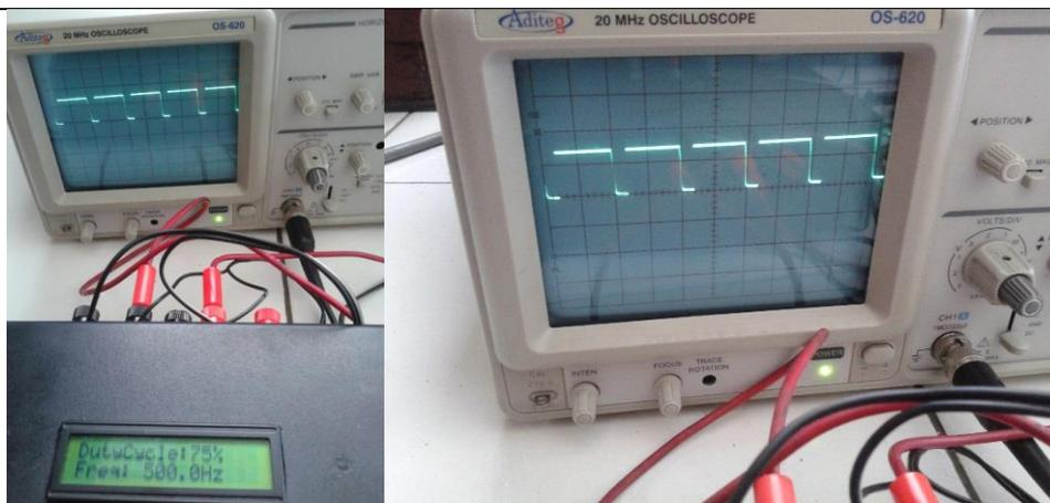
Pengujian PWM pada *Duty Cycle* 75% dan Frekuensi 500 Hz
