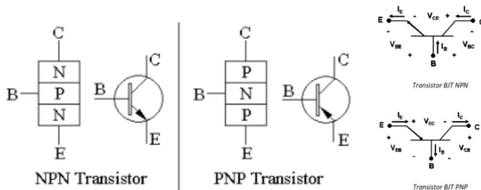
Gambar 2. 4. Simbol Transistor PNP dan NPN
