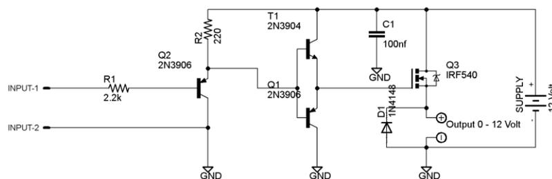
Gambar 3. 11. Skematik Driver Mosfet
