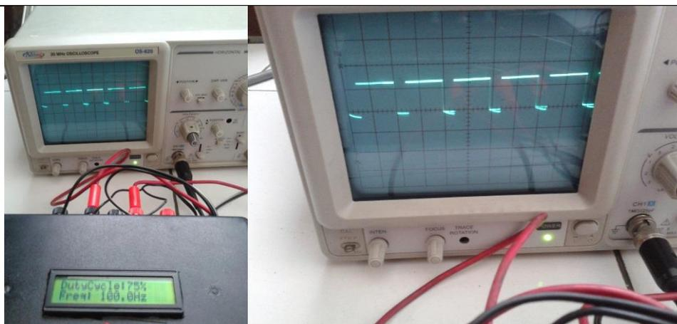
Pengujian PWM pada *Duty Cycle* 75% dan Frekuensi 100 Hz
