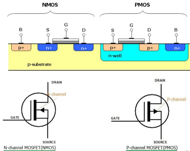
Gambar 2. 6. Transistor NMOS dan PMOS
