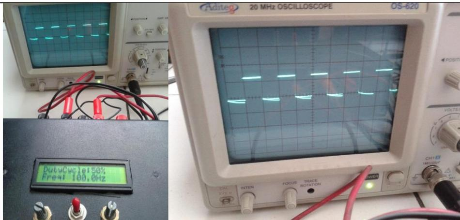
Pengujian PWM pada *Duty Cycle* 50% dan Frekuensi 100 Hz
