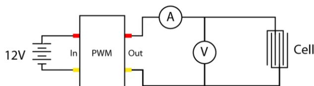
Gambar 3. 2. Rangkaian Pengujian Generator Elektrolisis dengan PWM
