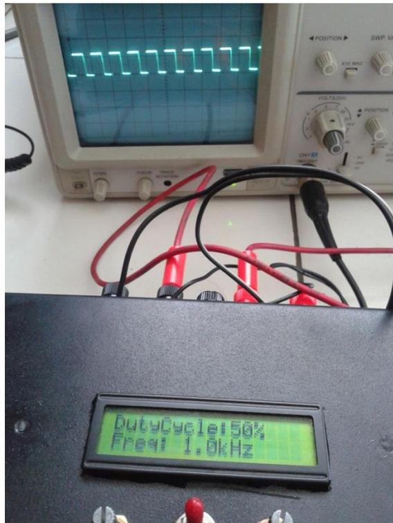
Gambar 4. 1. Pengujian PWM Frekuensi 1 kHz dan Duty Cycle 50%
