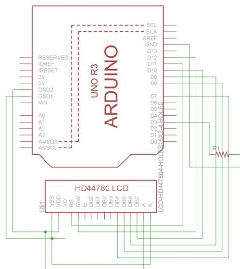
Gambar 3. 12. Rangkaian LCD, sebagai Indikator Dutycycle dan Frekuensi
