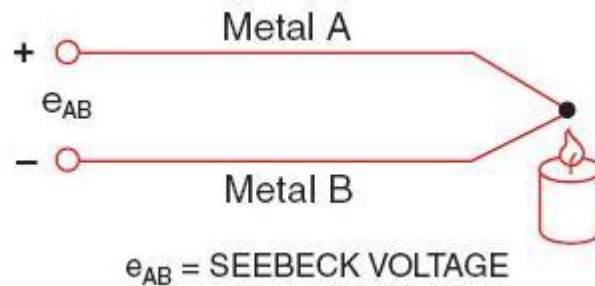
Gambar 2. 9. Cara Kerja Termokopel Tipe-K
