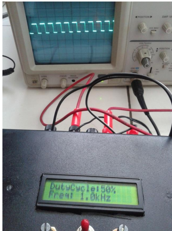
Gambar 4. 1. Pengujian PWM Frekuensi 1 kHz dan Duty Cycle 50%
