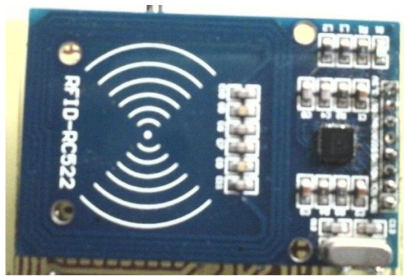
Gambar 2. 7 modul pembaca RFID RC522
