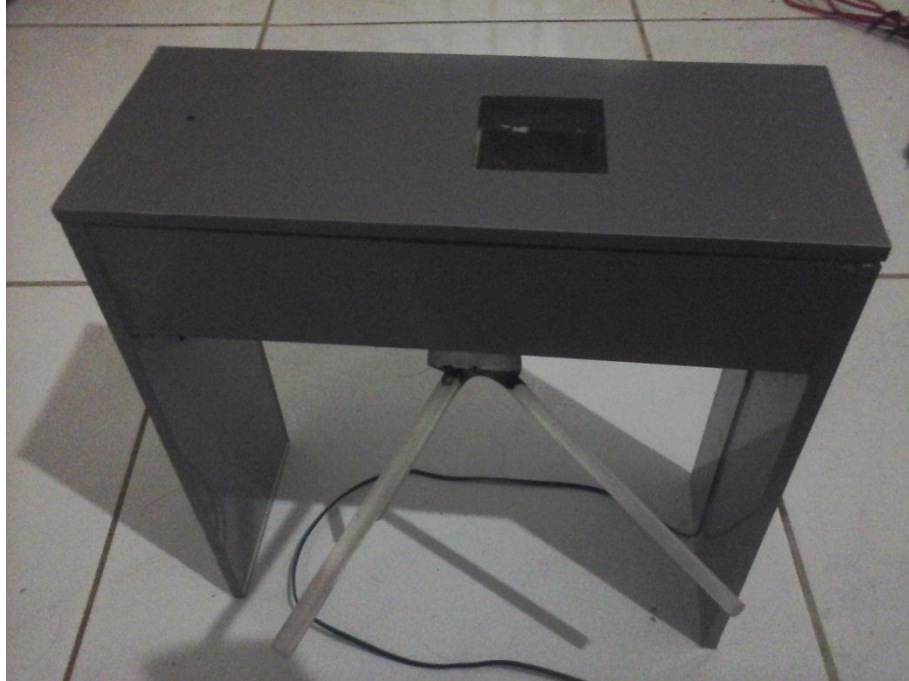
Gambar 4. 1 casing Gate stadion
