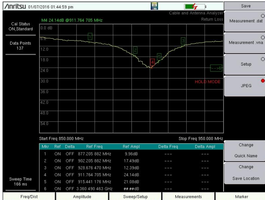
Gambar 4.8 Hasil Pengukuran Return Loss dan Bandwidth
