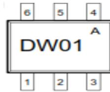
Gambar 2.23. Konfigurasi Pin IC DW01A
