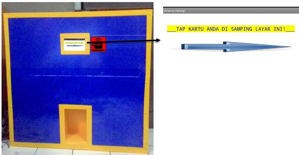
Gambar 4.1 Alat Pembuat Kopi Otomatis Berbasis Arduino Mega 2560 dengan Menggunakan RFID Card Sebagai Alat Pembayaran (tampak depan)
