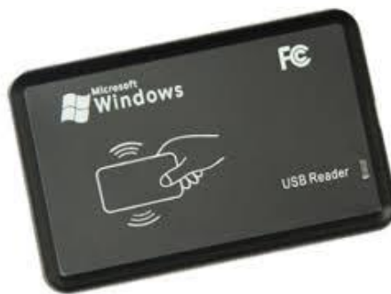
Gambar 2.9 Bentuk fisik RFID Reader
