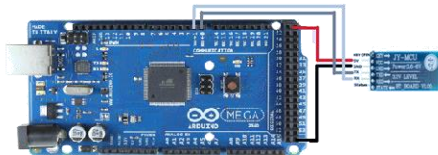
Gambar 3.5 Koneksi Pin Modul Bluetooth dengan Arduino
