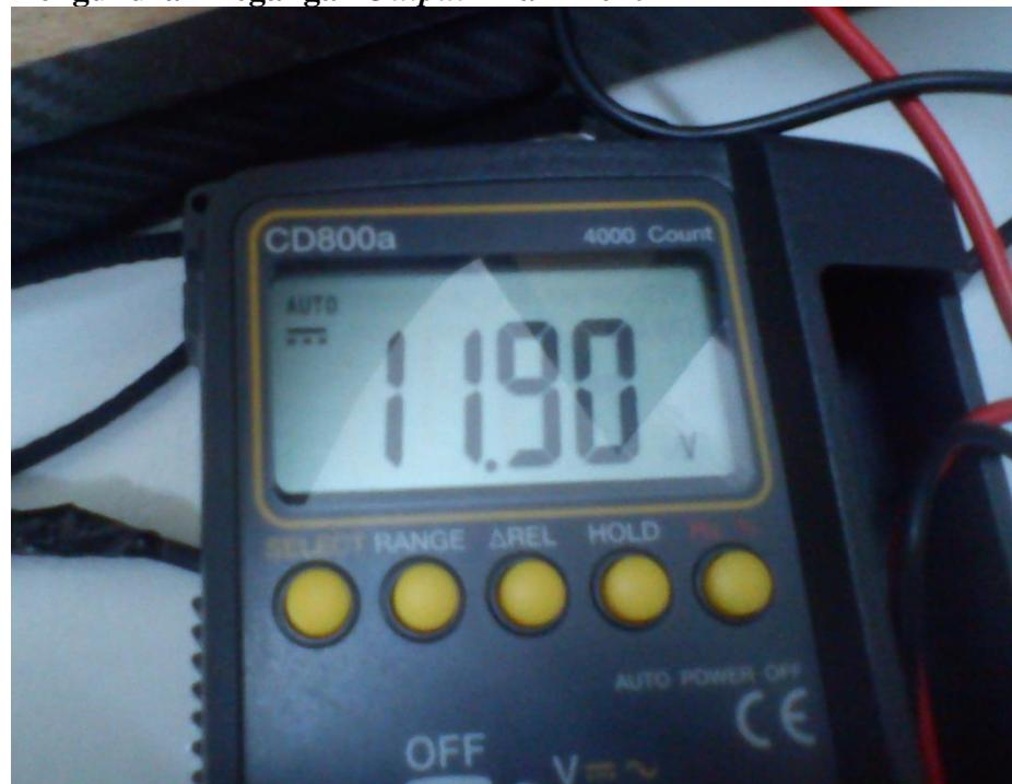
**4. Pengukuran Tegangan *Output* Relay Pemanas**
