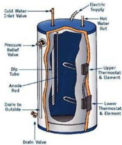
Gambar 2.6 Pemanas Air Listrik
