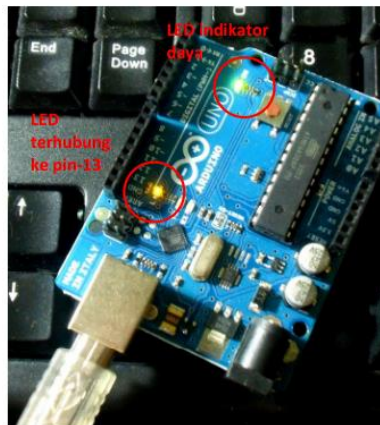
Gambar 2.11 Papan Arduino Uno Saat Aktif Sumber : Feri Djuandi, E-Book Pengenalan Arduino
