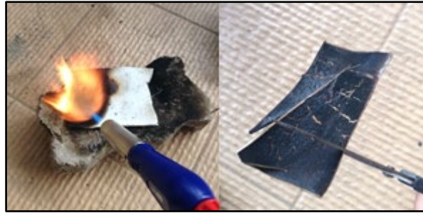
Gambar 4.29 Pembakaran pipa pvc dan pemotongan sesuai garis pola K2
