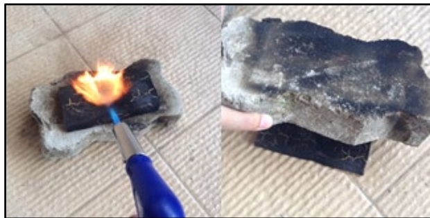
Gambar 4.21 Pemipihan pipa pvc (Sumber: dokumentasi pribadi)
