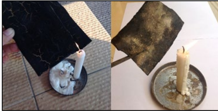
Gambar 4.2 Proses pemanasan pvc menggunakan api lilin (Sumber: dokumentasi pribadi)
