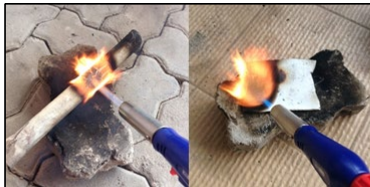
Gambar 4.3 Proses pemanasan pvc menggunakan las api (Sumber: dokumentasi pribadi)
