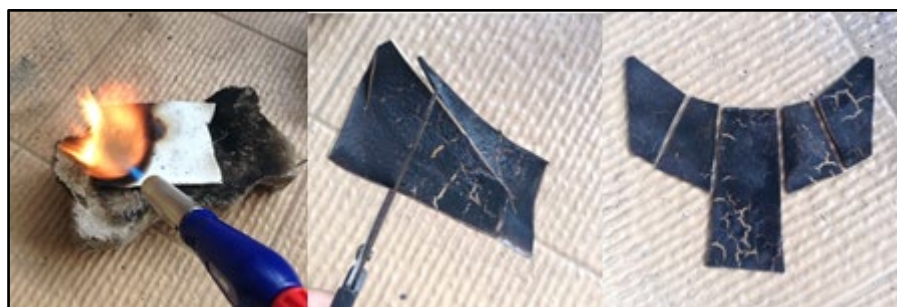
Gambar 4.24 Pembakaran pipa pvc dan pemotongan sesuai garis pola K1 (Sumber: dokumentasi pribadi)
