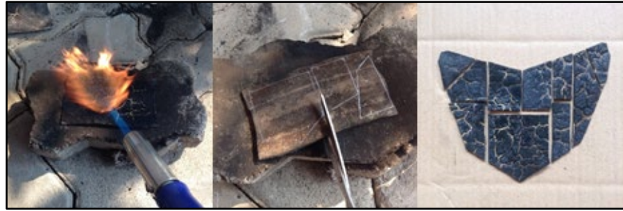
Gambar 4.39 Pembakaran pipa pvc dan pemotongan sesuai garis pola K4
