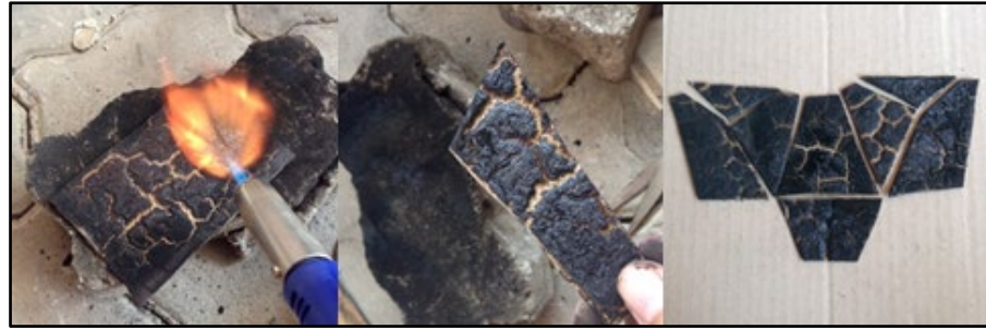
Gambar 4.44 Pembakaran pipa pvc dan pemotongan sesuai garis pola K5
