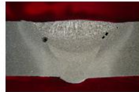
Gambar 2. Pemeriksaan makro etsa terhadap sampel kode D2- tanpa di oven, material baja karbon rendah. Etsa: nital 8%
