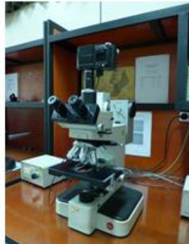
Mikroskop Optik perbesaran 5x s/d 1000x
