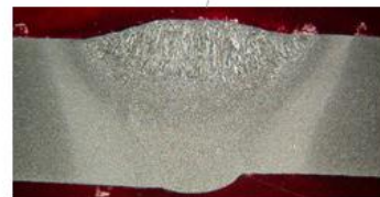
Gambar 6. Pemeriksaan makro etsa terhadap sampel B2 - elektroda las dipanaskan dalam oven 245 °C, material baja karbon rendah. Etsa: nital 8%
