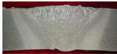
Gambar 4. Pemeriksaan makro etsa terhadap sampel A2 - elektroda las dipanaskan dalam oven 230 °C, material baja karbon rendah. Etsa: nital 8%
