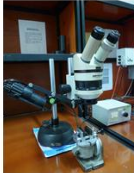
Mikroskop stereo perbesaran 6x s/d 50x
