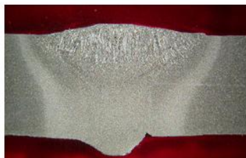
Gambar 8. Pemeriksaan makro etsa terhadap sampel C2 - elektroda las dipanaskan dalam oven 260 °C, material baja karbon rendah. Etsa: nital 8%
