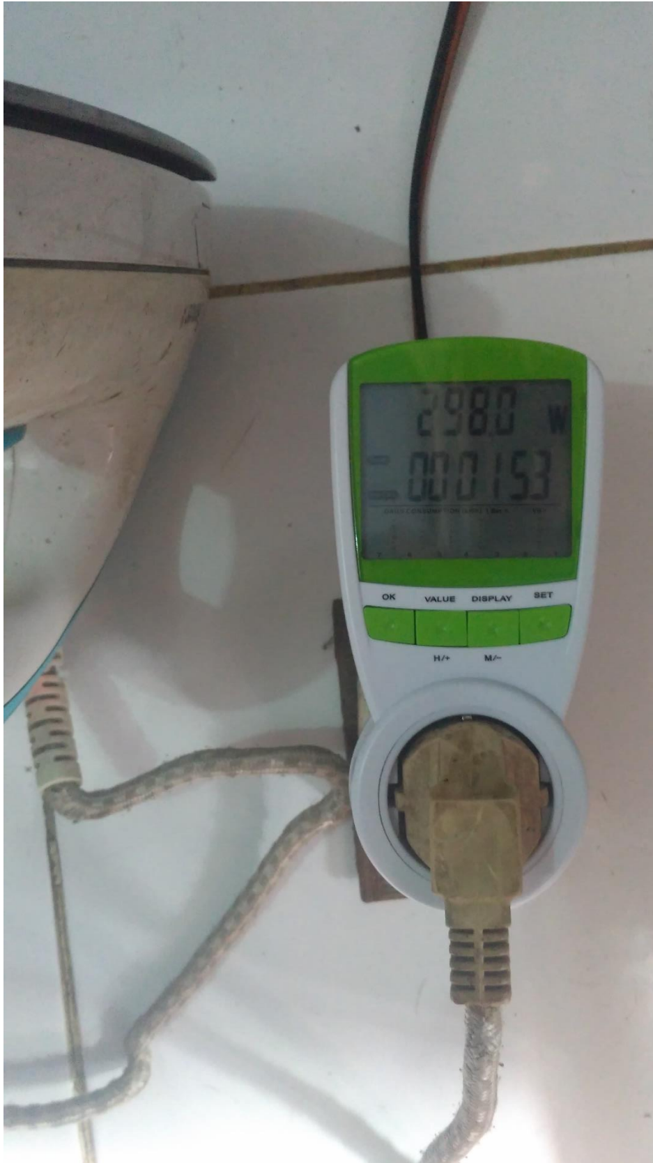
Gambar 4.15 Pengujian Taff DEM1499 Pada Setrika Listrik Cosmos
