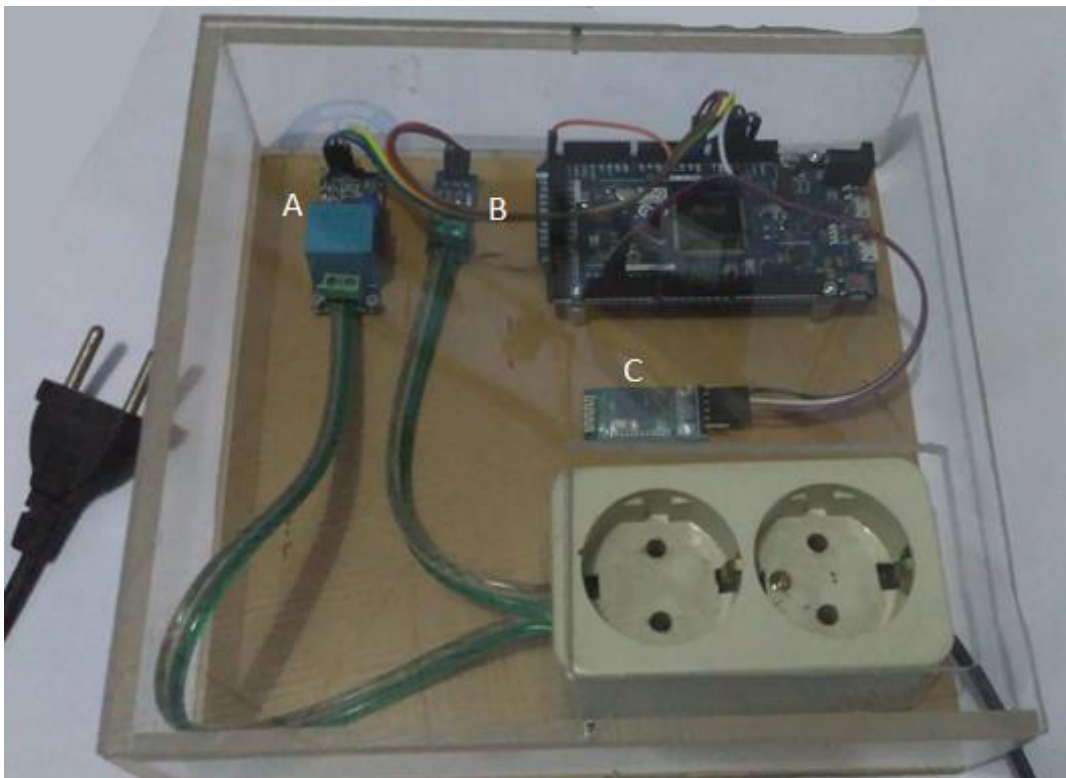
Gambar 4.1 Rangkaian Pengolah dan Pengirim data ( V_{rms} , I_{rms} dan S )
