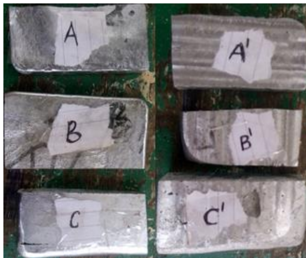
Gambar 3.7 Spesimen setelah proses cutting
