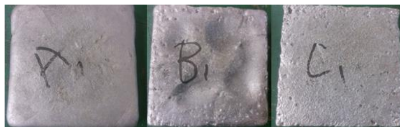
Gambar 3.5 Spesimen hasil pengecoran pada cetakan pasir
