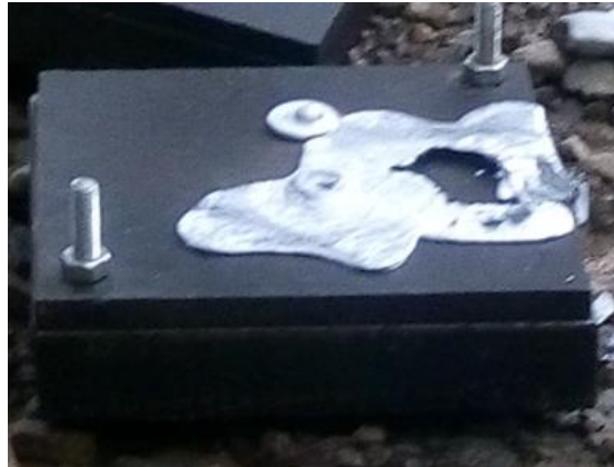
Gambar 3.4 Cetakan logam yang telah terisi logam cair
