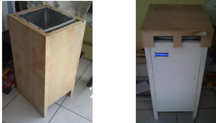
Gambar 3.7. Lapisan Triplek pada Rancangan Prototipe Silo
