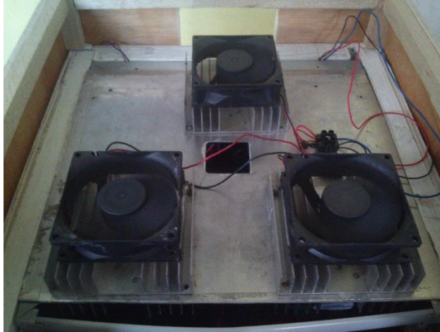
Gambar 3.3. Pengatur Suhu pada Prototipe Silo
