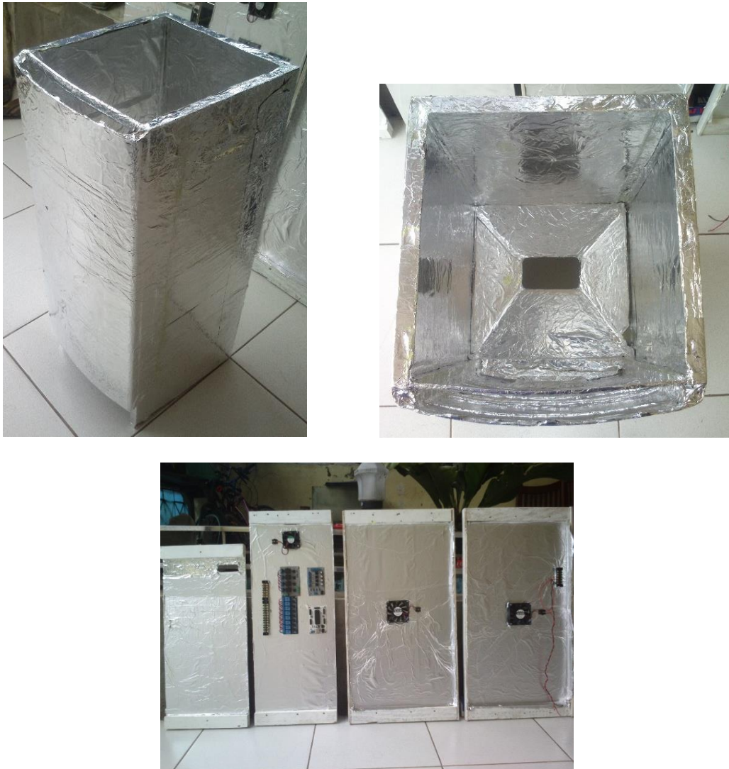
Gambar 3.6. Lapisan Aluminium Foil pada Rancangan Prototipe Silo
