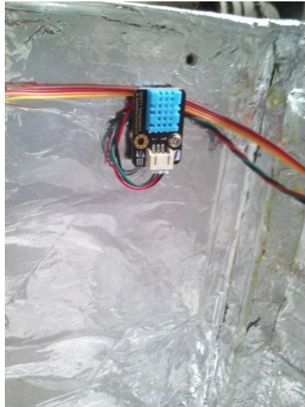
Gambar 3.2. Posisi Sensor Temperatur dan Kelembaban
