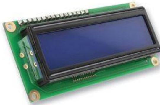
Gambar 2.16. Bentuk Fisik LCD Karakter 16 x 2 (Sumber: www.newark.com )
