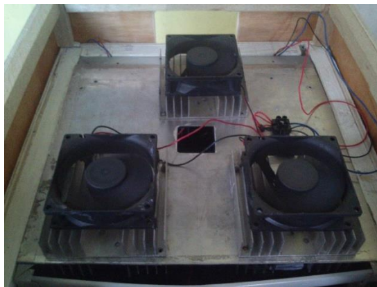
Gambar 3.8. Pengatur suhu dan Pemanas pada Rancangan Prototipe Silo
