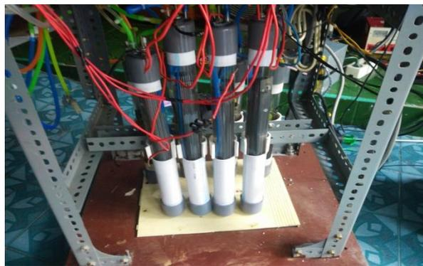
**Gambar 4.1. Alat Penghasil Gas Hidrogen**
