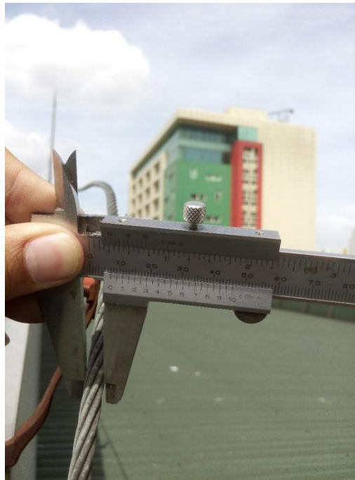
Pengukuran Diameter Kabel Konduktor
