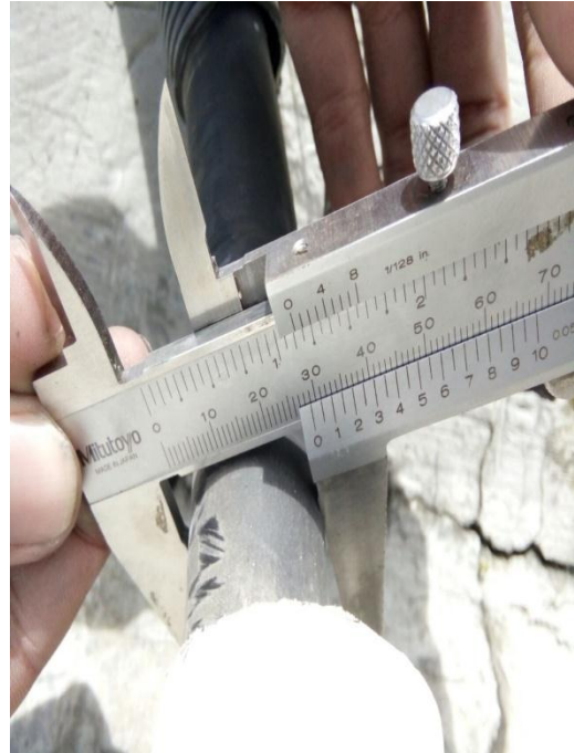
Pengukuran Diameter Kabel Konduktor
