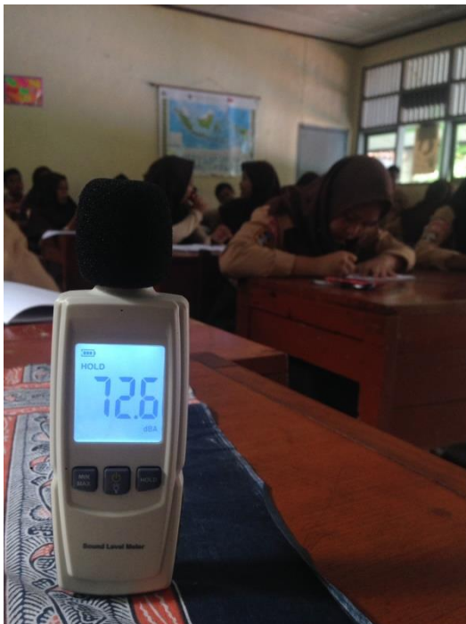
Kebisingan pesawat terbang yang terjadi di kelas ketika pesawat melintas setelah diukur dengan Sound Level Meter adalah 72,6 dB(A)
