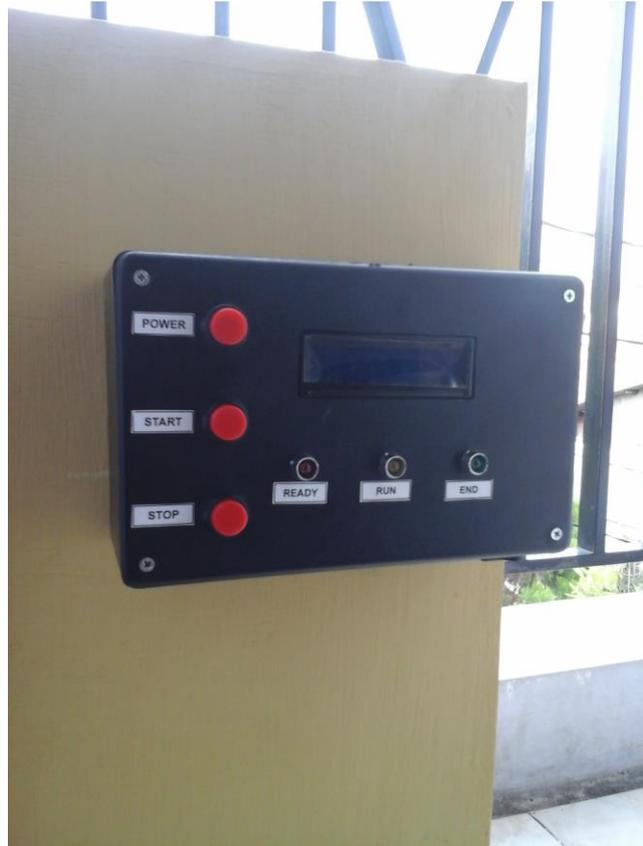
**Gambar 3.7. Realisasi Panel Kontrol atau *Control Board***
