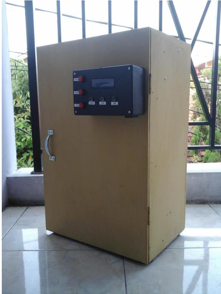
**Gambar 3.5. Realisasi Bagian Depan Lemari Pengering Rumput Laut Berbasis Arduino**
