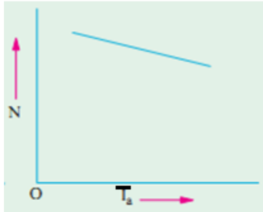
Gambar 2.11 Grafik karakteristik kecepatan terhadap fungsi torsi jangkar
