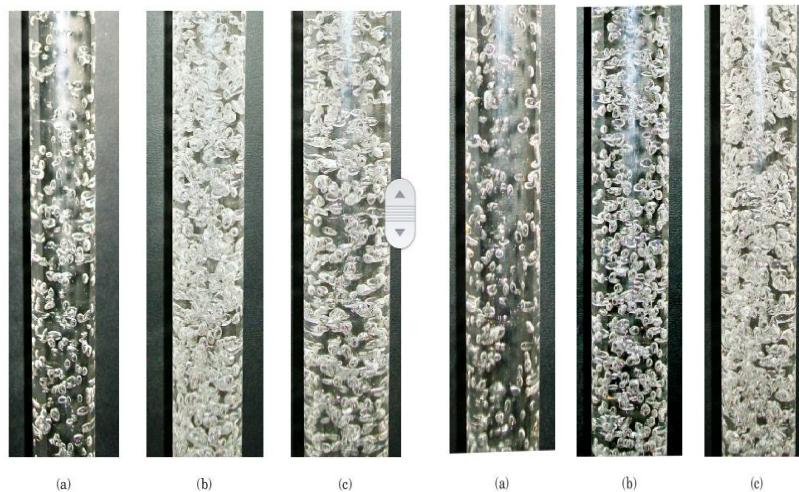
Gambar 4. Visualisasi dari bubbly flow pada pipa uji vertikal dengan ketinggian 0,35 m di atas bubble injector untuk Re_{SL} = 31492 ( U_{SL} = 0,7 m/s)
