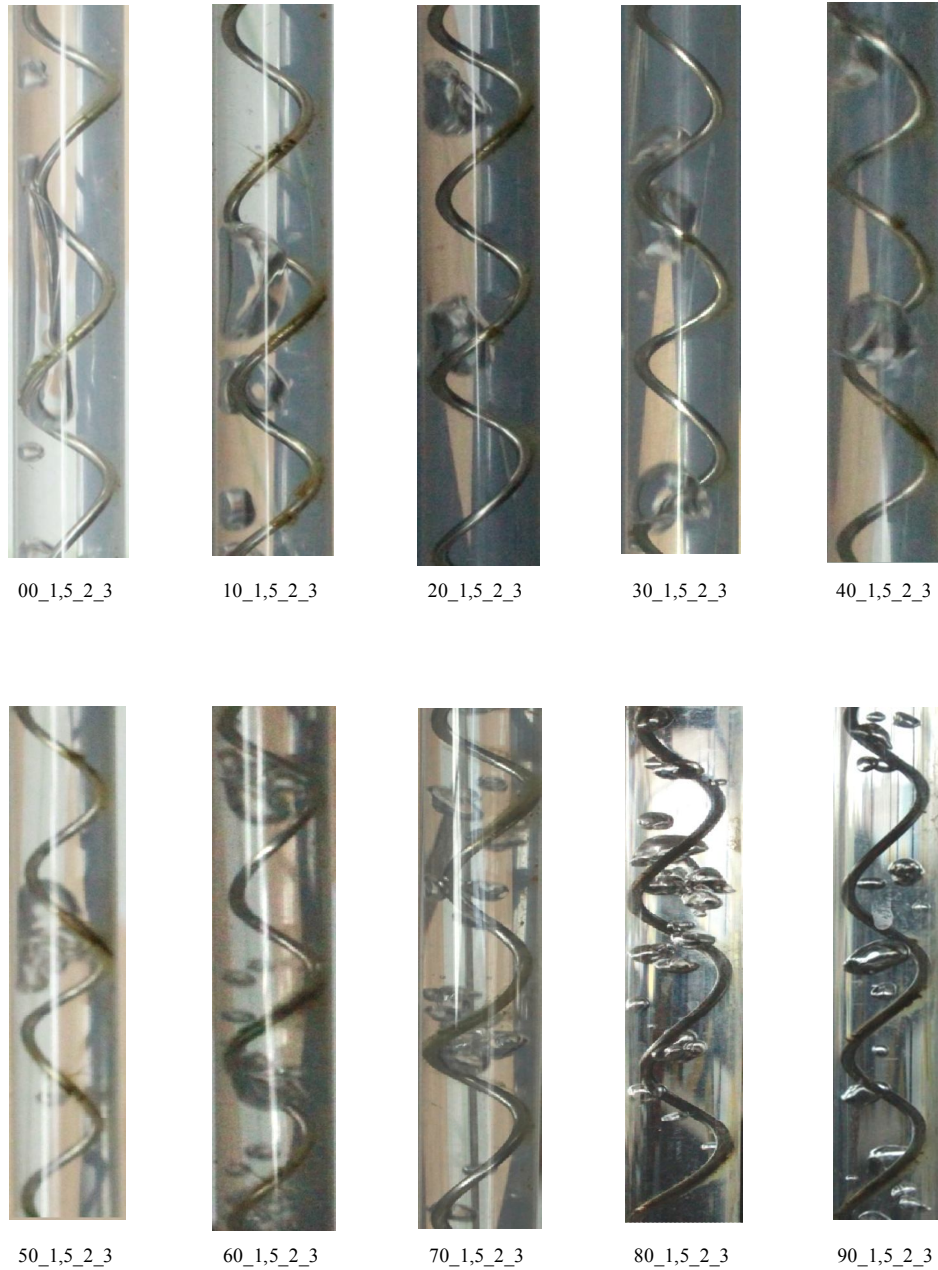
Gambar 4.13 pengaruh kemiringan pipa dengan perubahan 10^0 terhadap distribusi gelembung udara dengan debit air 1,5 liter/menit dan debit udara 0,2 liter/menit.
