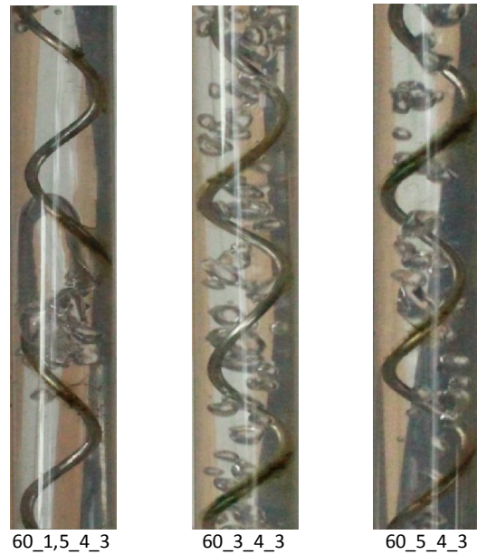
Gambar 4.11 pengaruh penambahan debit air pada gelembung udara pada sudut 60^\circ , debit udara 0,4 liter/menit dan debit air 1,5 liter/menit, 3 liter/menit dan 5 liter/menit.
