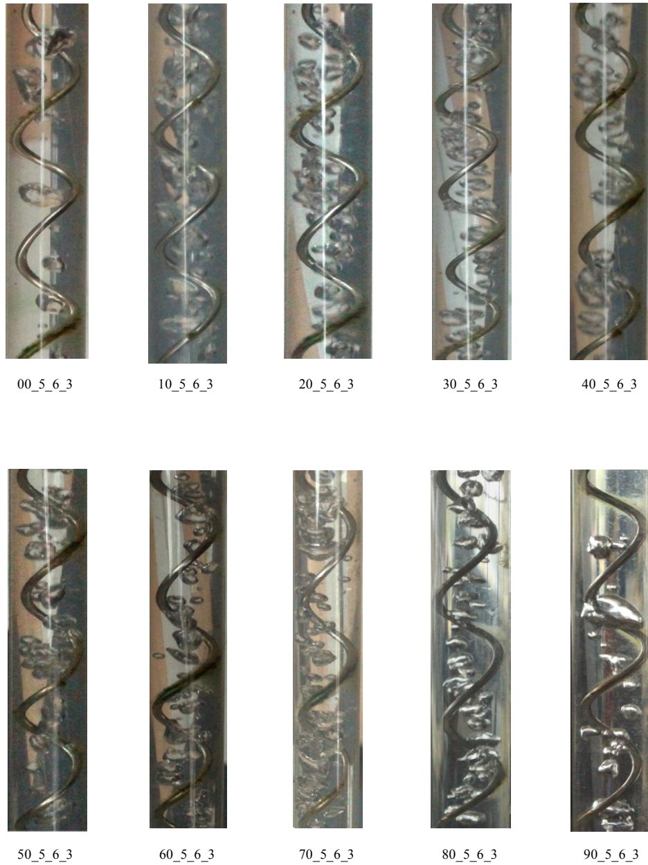
Gambar 4.14 pengaruh kemiringan pipa dengan perubahan 10^0 terhadap distribusi gelembung udara dengan debit air 5 liter/menit dan debit udara 0,6 liter/menit.
