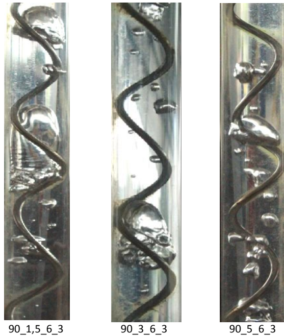
Gambar 4.12 pengaruh penambahan debit air pada gelembung udara pada sudut 90^{\circ} , debit udara 0,6 liter/menit dan debit air 1,5 liter/menit, 3 liter/menit dan 5 liter/menit.
